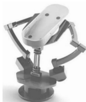
(d) 2-RRR/UPRR Ankle Rehabilitation Robot (e) 3-RRRRR Parallel Robot (f) 3-RRS Parallel Rehabilitation Robot
